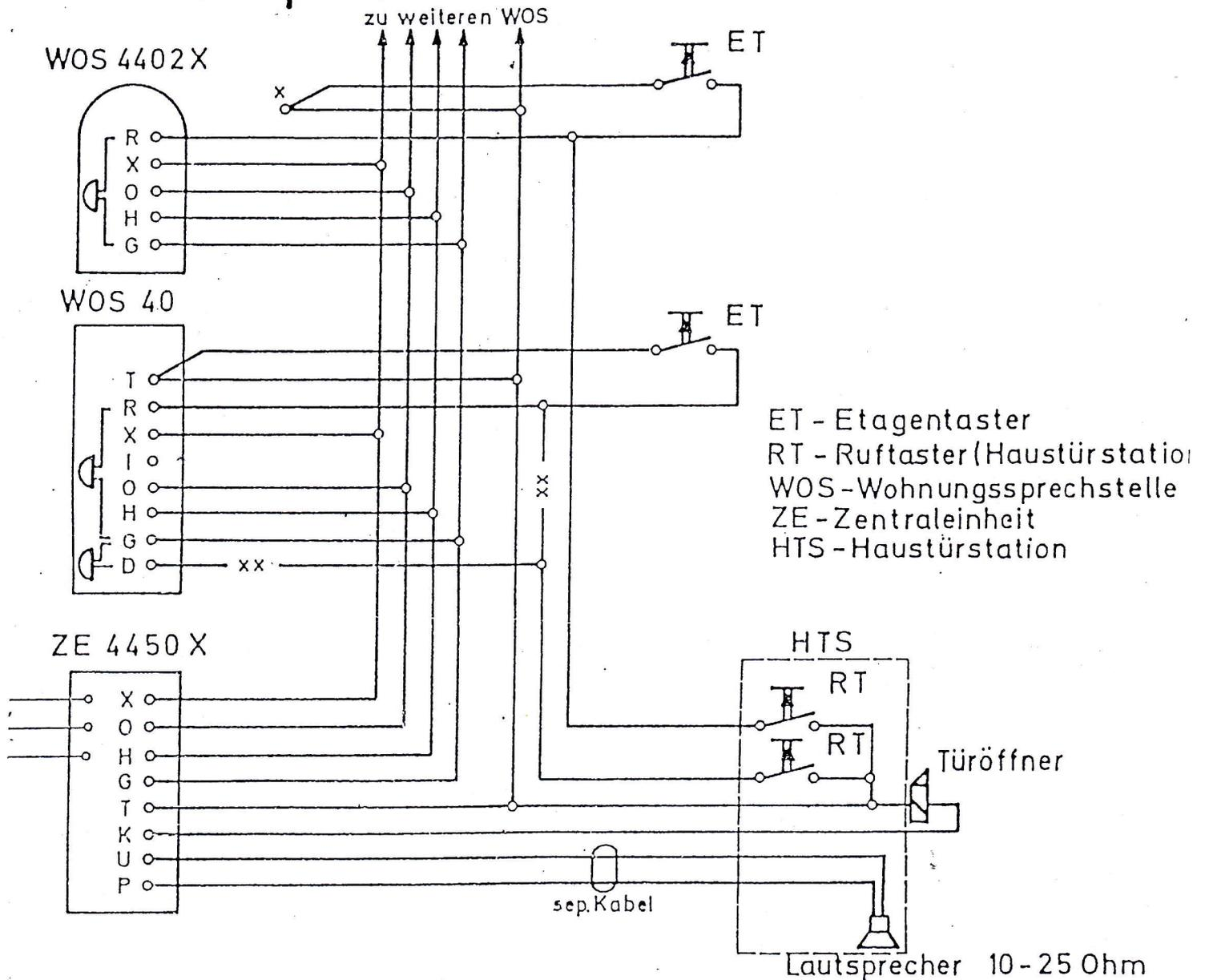
Die Zentraleinheit ZE 4450 X ist Ersatz für die Verstärkertypen MVS 41, MVS 43, MVS 41/3 und ZE 4050 B.
